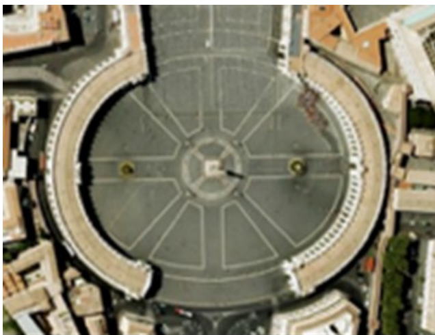
Piazza San Pietro a Roma, progettata da Gian Lorenzo Bernini, ha la parte terminale del colonnato di forma ellittica. I fuochi dell'ellisse sono evidenziati sulla pavimentazione. Ponendosi in quel punto e osservando la parte più vicina del colonnato si può notare l'allineamento delle colonne.
